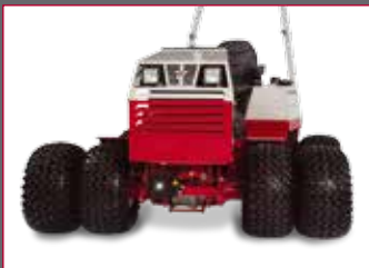
DUBBELMONTAGE Ökar stabiliteten, dragkraften och säkerheten vid släntkörning.
