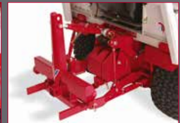
REDSKAPSFÄSTE BAK Med detta fäste kan du även koppla på en del av de frontmonterade redskapen bak på maskinen.
