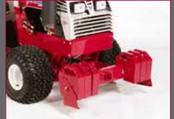
2-I-1-FÄSTE Monteras fram på maskinen. Med fästet kan du frontmontera dragkulan. Stabiliserar maskinen genom att hänga på bärbara vikter (tillval) när tunga redskap tillkopplas baktill. Används när du kör redskap med 3-punktslyft för att fördela vikt till alla fyra hjulen.
