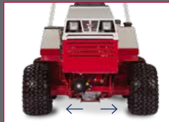
HJULBREDDARE Ökar stabiliteten vid körning i slänter upp till 25 graders lutning.
